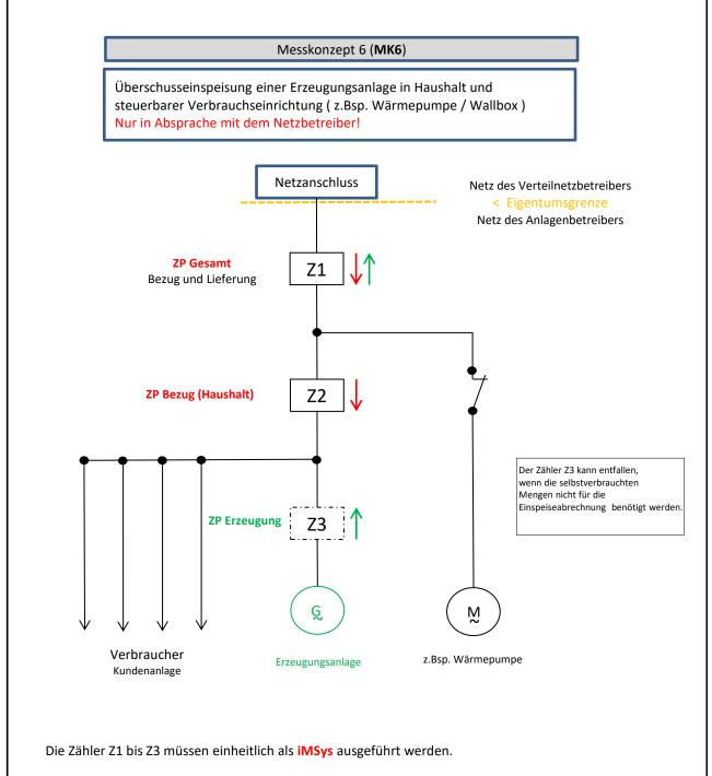
Alle von der Bigge Energie eingesetzten SLP Zähler werden i.d.R. als Zweienergierichtungszähler ausgeführt.
